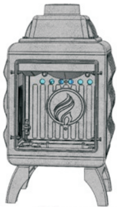
Рис. 3 – Система вторичного дожига внутри топочной камеры
