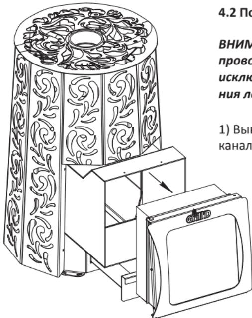
2) Установить печь и экран на место постоянной эксплуатации. Экран должен опираться на пол или опору так, чтобы ножки печи и нижняя поверхность экрана лежали в одной плоскости.
