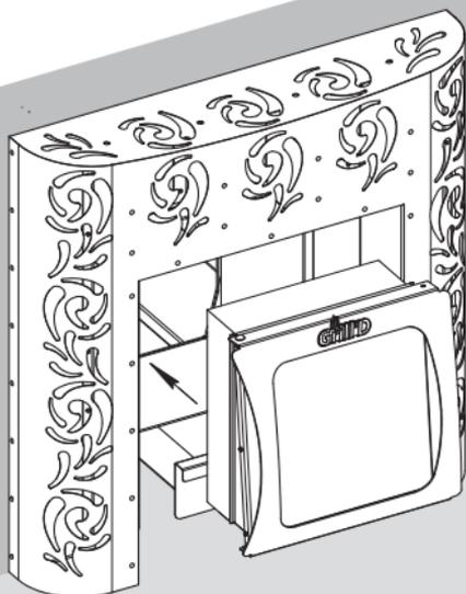
3) Вставить выдвижную часть топочного канала в неподвижную на необходимую глубину (экран должен прижаться к стене рамкой дверцы), закрепить.
