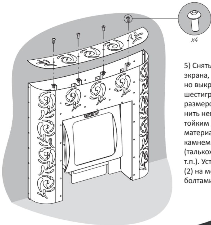
5) Снять крышку (2) экрана, предварительно выкрутив болты (3) шестигранным ключом размером 5 мм. Заполнить негорючим, водостойким декоративным материалом, например, камнем для бань и саун (талькохлорит, жадеит и т.п.). Установить крышку (2) на место и закрепить болтами (3).
