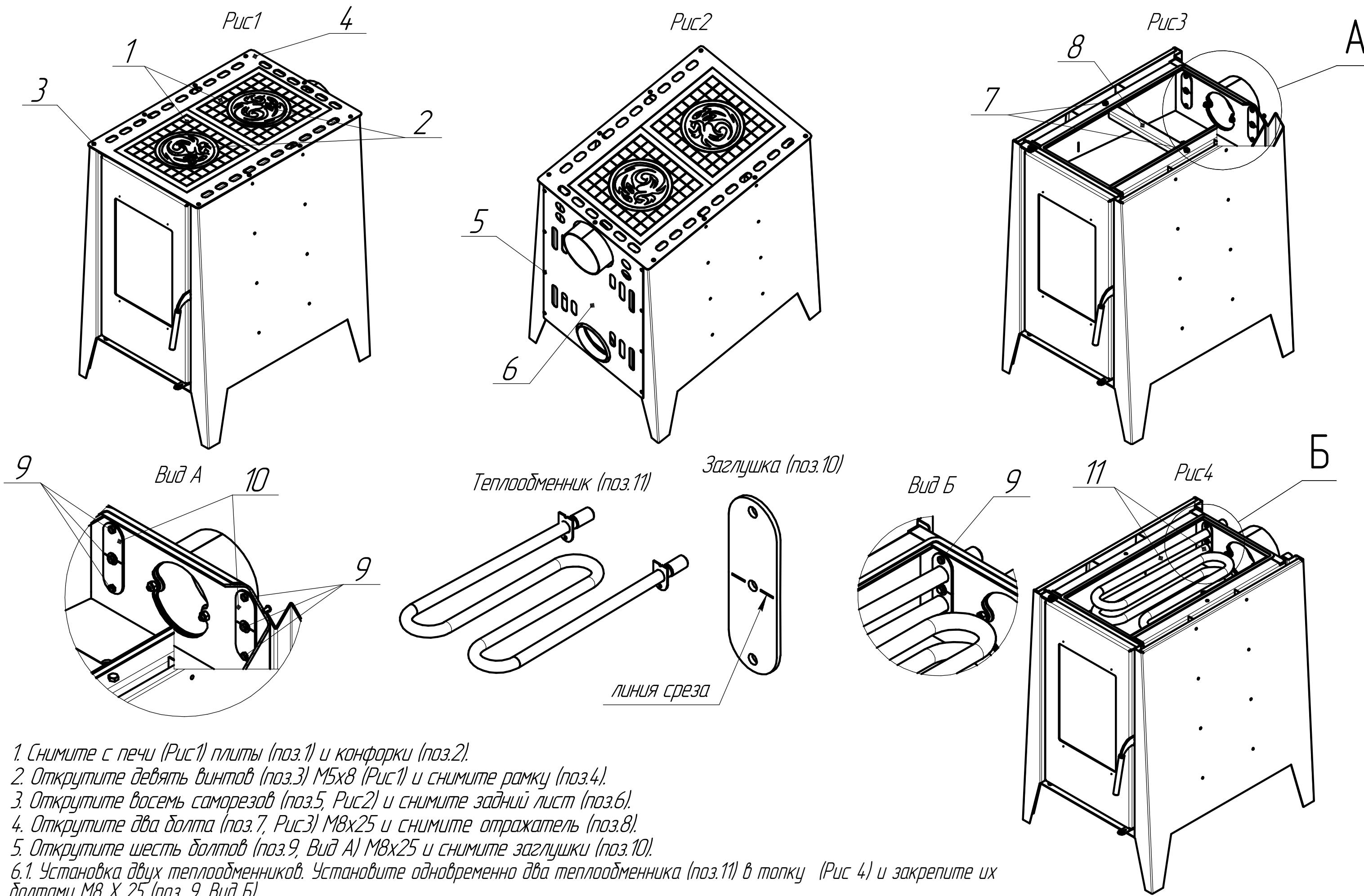
1. Снимите с печи (Рис1) плиты (поз.1) и конфорки (поз.2).
