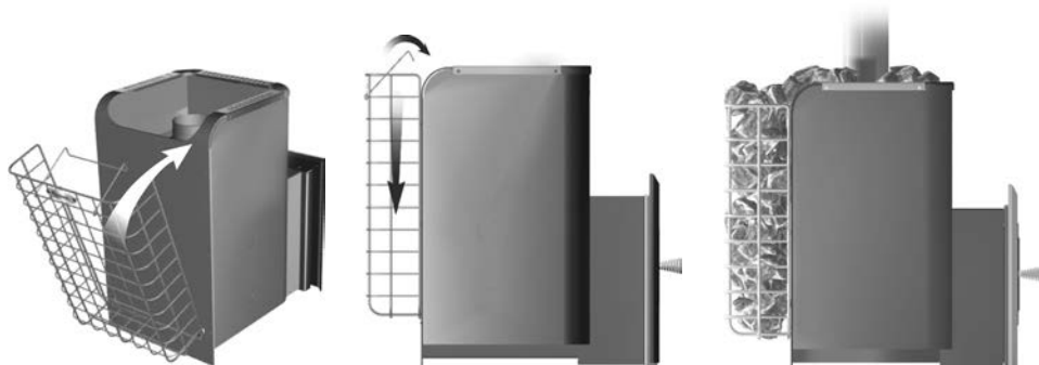
Рисунок- 10. Установка сетки-каменки на печь.
