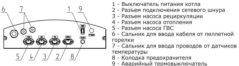
Рис.6. Расположение органов управления на задней панели пульта.
